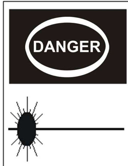
LABELS AND SIGNS FOR CLASS III AND CLASS IV LASERS ONLY (BLANK FORMAT) ÉTIQUETTES ET PANNEAUX LASER DES CLASSES III ET IV SEULEMENT (MODÈLE EN BLANC)
